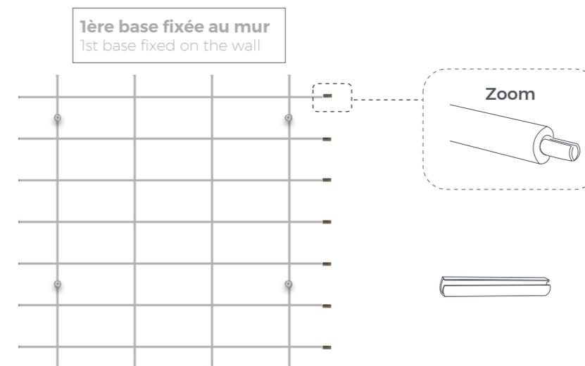
Insérer les goupilles aux extrémités des tiges de connexion
