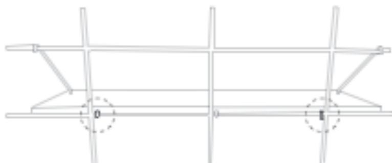
Placez les planches de telle sorte que les 2 taquets situés aux 2 extrémités de la planche soient bloqués à l'intérieur des intervalles formés par les tiges verticales de la base murale
